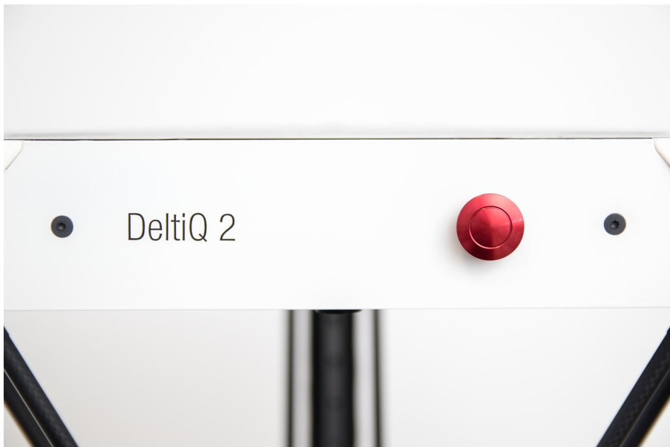
Tiskárna stisknutím tlačítka provede svůj kompletní restart a je připravena k dalšímu provozu. Před ním je však třeba odstranit například přerušovaný tisk z podložky a podložku znovu nachystat. V případě nestandardního chování tiskárny, jejího poškození nebo oddělení některých součástí kontaktujte, prosím, servisní pracovníky dodavatele.
